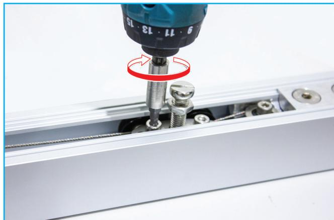
**6.** Säädä Soft close-ovihidastimien virityspinnejä siten, että ovihidastimet pysäyttävät suunnilleen oikeassa kohdassa. Älä ylikiristä pinnejä, jotta ei muovikierteet pinnissä korkkaa.
